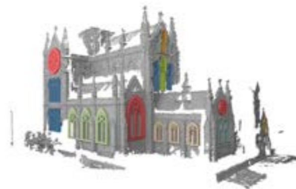
Abb. 2 Eine umfangreiche Exemplardatenbasis ermöglicht das Erkennen von Teilsymmetrien, die das Rekonstruktionsergebnis in Bereichen geringer Datenqualität deutlich verbessern.
